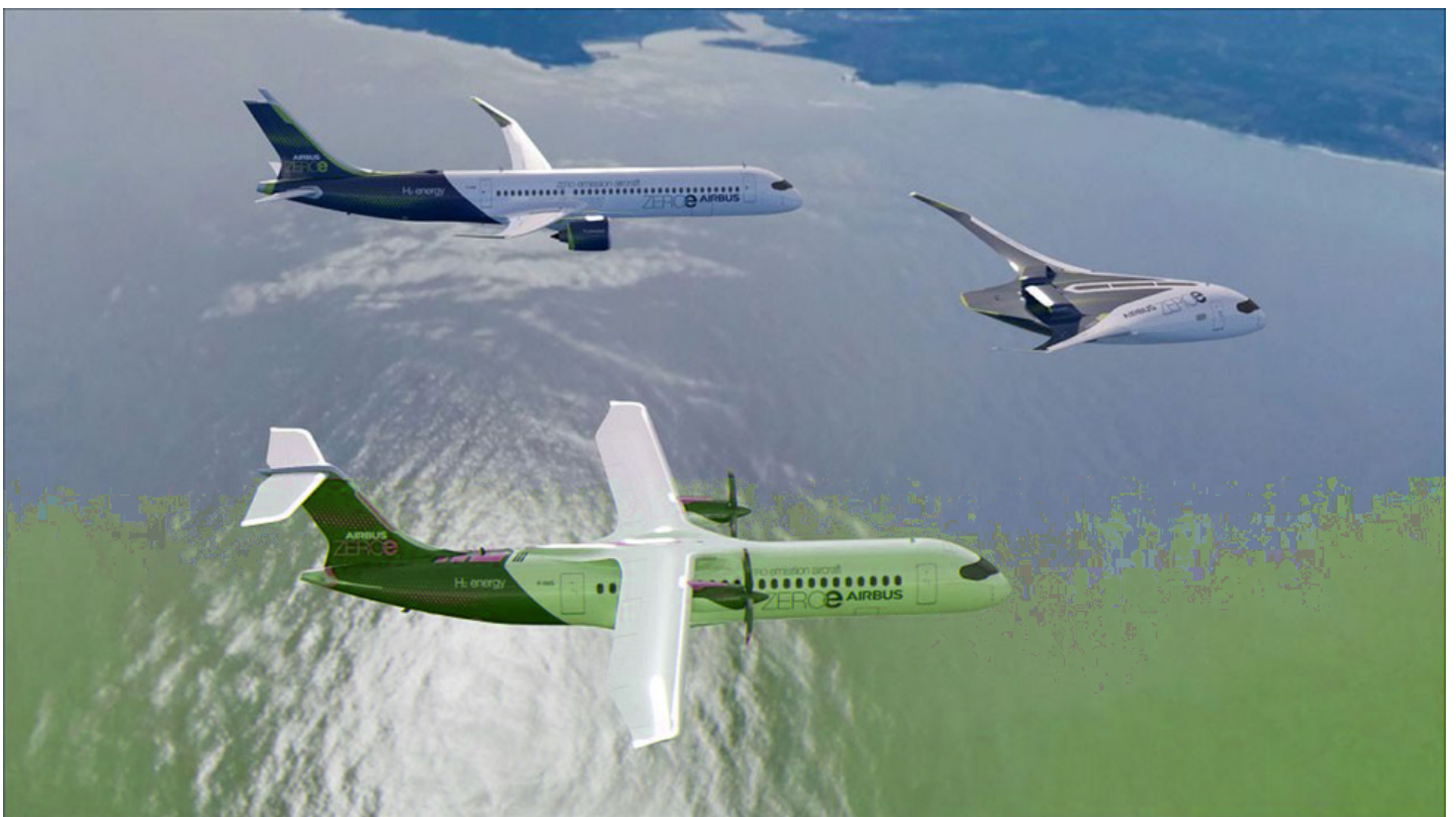
Les trois concepts d'avion à hydrogène d'Airbus : régional, moyen-courrier et à plus longue échéance, l'aile volante long-courrier. (Airbus)
